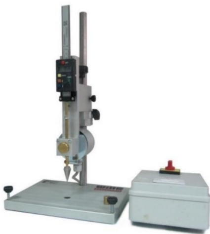
Fig. 2 Fall cone (FC) test apparatus
