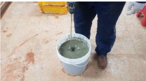
(d) Stirring process of GGBS-CB slurry for 3 min.
