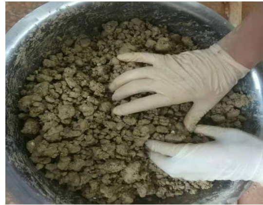
(d) Mix the soil with the microbial solution
