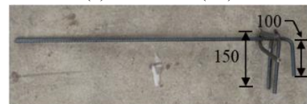
(d) 90° standard hook+U-shaped bar (HoU)
